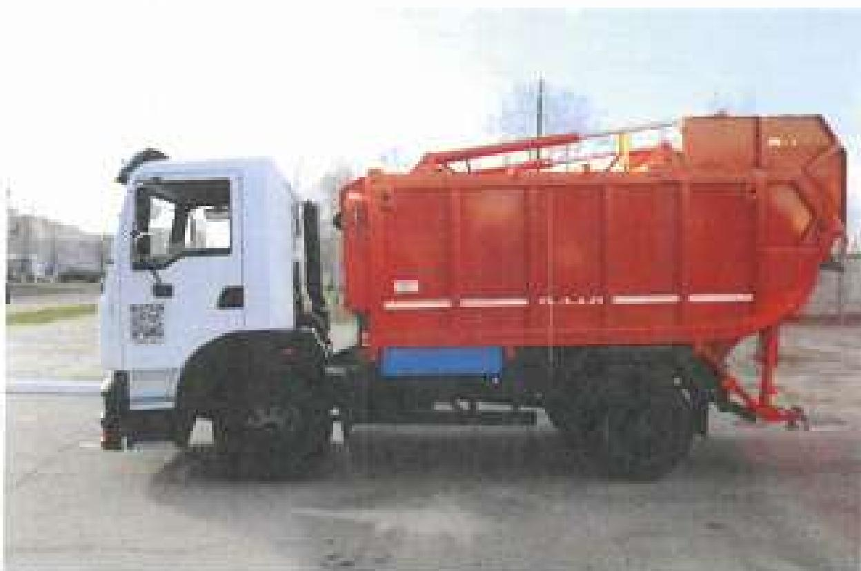
Сміттевоз являє собою автомобільне шасі КрАЗ-5401.Н2 (4x2), на якому змонтоване спеціальне обладнання: бункер, винтовувальна пінта, підйомна задня частина, маніпулятор (ліфттер), трансмісія та масляним насосом, гідросистема, електрообладнання.
