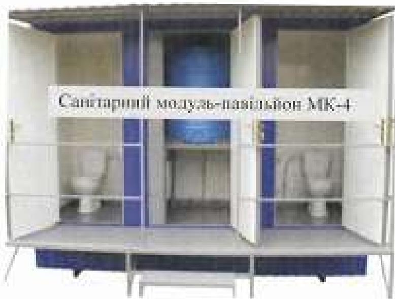
Панелі, що утворюють корпус і дах виготовлені з профільованої труби і зовні обшиті металом фірми «RANNILA» (гарячооцинкована тонколистова сталь з різними типами полімерних покриттів, зберігає свої властивості до 50 років) синього кольору. Усередині утеплені утеплювачем, обшиті вагонкою. На підлозі лінолеум.
