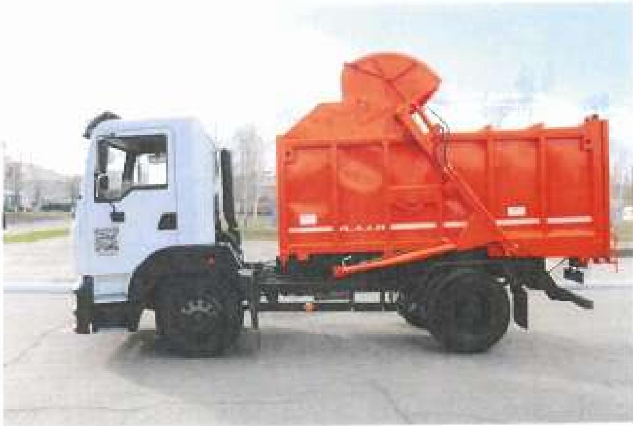
Сміттєвоз з являє собою автомобільне шасі, на якому встановлене спеціальне обладнання: бункер, підйомний ківш, трансмісія з місячним насосом, гідросистема, електрообладнання.
