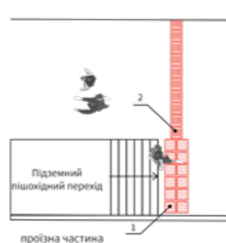
Рисунок 34 — Приклад можливого застосування інформаційної ТС перед підземним переходом: 1 - попереджувальна ТС; 2 - інформаційна ТС
